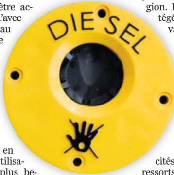
**Le bouchon diesel**, une fois fixé, n'a plus à être déviscé. Seuls les pistolets à diesel peuvent en actionner l'ouverture.
