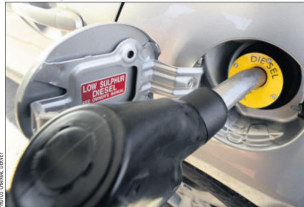
**COMMENT ÇA MARCHE?** Le diamètre des pistolets diesel est de 25 mm, celui des pistolets à essence de 21 mm seulement. Grâce à un système de «doigts» rétractables, la trappe du bouchon mis au point par les frères de Gol ne s'ouvre que si le tuyau de remplissage a la largeur requise. S'il est trop étroit, le clapet reste verrouillé. Son étanchéité répond à des normes internationales.
